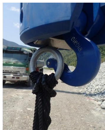
図-2 磁石式オートリリースフックの概要 (Overview of the magnetic auto-release hook)
